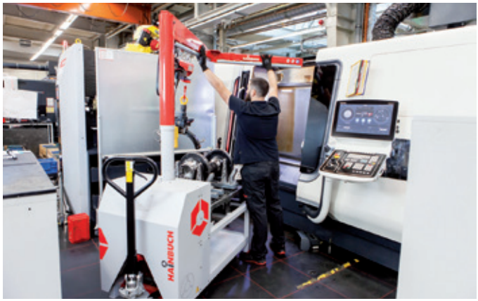
Das Rüstmobil ermöglicht ohne Hallenkran den schnellen Spannittelwechsel in jeder Fertigungshalle.
