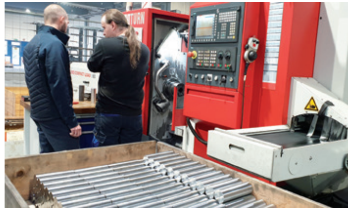
Drehteile werden bei der Beer Zerspanungstechnik grundsätzlich von der Stange gefertigt. Entsprechend häufig ist ein Abstecherwerkzeug gefragt.
