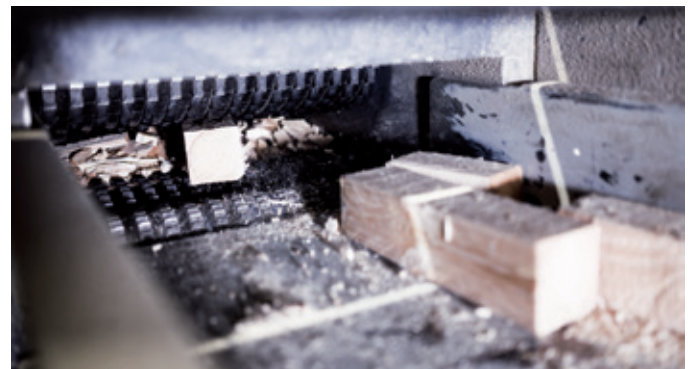
Die abgesiebten Überlängen sowie anfallende Kappstücke aus der Brettsortierung werden über Bänder und Vibrorinnen zum Trommelhacker transportiert.
