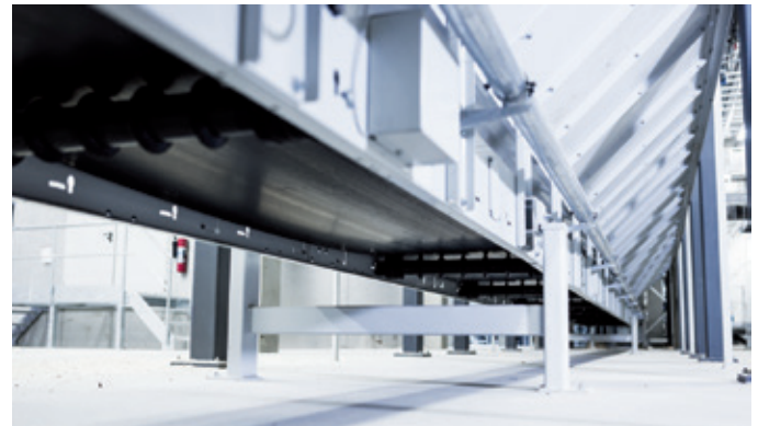
Um das Restholz für die Pelletsproduktion aufzubereiten, fällt es direkt vom Sägewerk auf die Fördertechnik.
