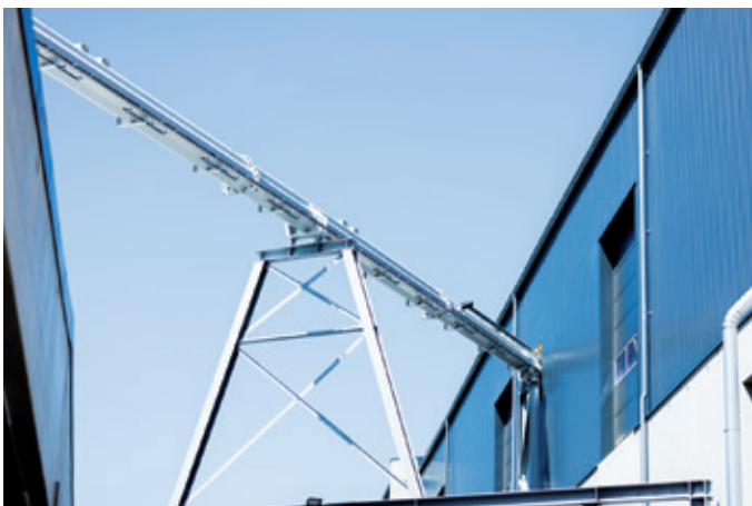
Der Vecobelt transportiert das Material quer über den Hof zu den Lagerboxen und der Siebstation und anschließend weiter zur Pelletverarbeitung.
