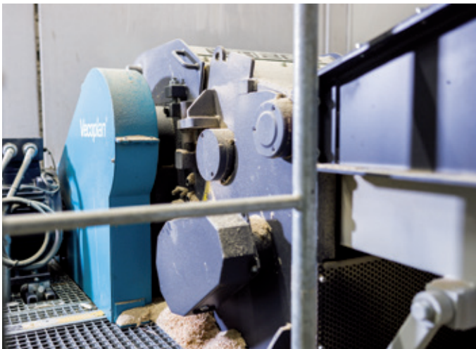
Der Trommelhacker zerkleinert das anfallende Restholz auf eine trocknerfähige Spangröße.
