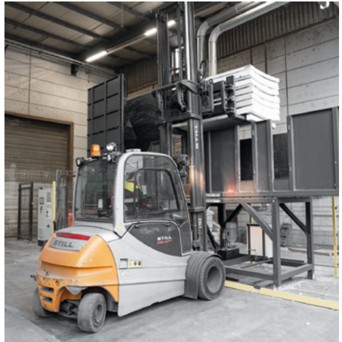
Dämmplatten werden vom Gabelstapler auf den Kipptisch gelegt.
