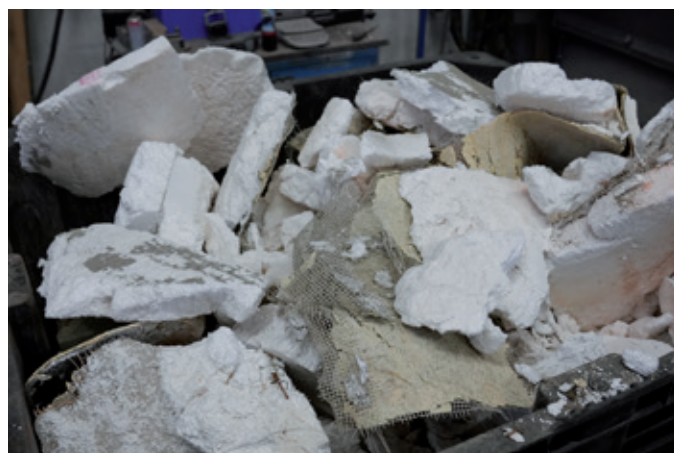
Probenmaterial aus maschinellem Rückbau eines Wärmedämmverbundsystems (WDVS).
