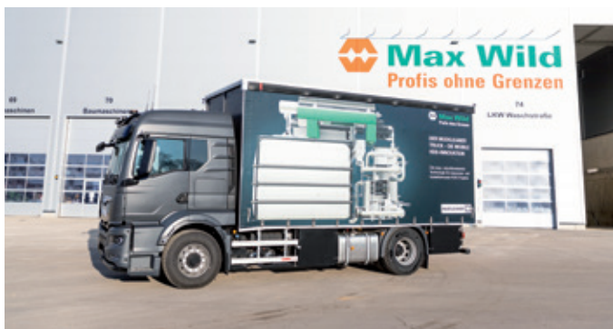
Inhouse-Innovation von Max Wild: der Mudcleaner-Truck zur Aufbereitung von Bohrschlämmen aus dem HDD-Verfahren.
