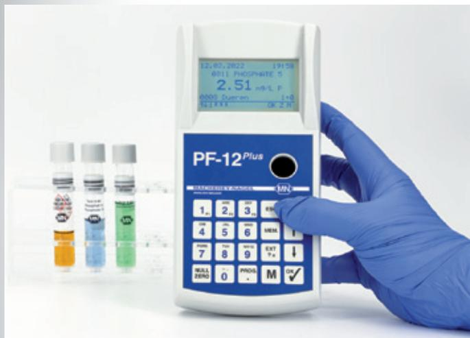
Durch den im Lieferumfang enthaltenen, robusten und mit hilfreichem Zubehör ausgestatteten Koffer kann das PF-12<sup>Plus</sup> ideal für die Analytik am Ort der Probenahme eingesetzt werden.
