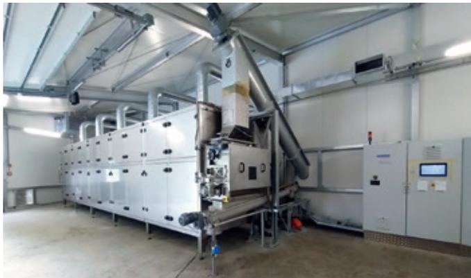
Ein Bandtrockner mit 5 Einheiten trocknet Klärschlamm aus drei Gemeinden in Tirol. Mit dieser effizienten Wärmepumpentechnologie wurde eine äußerst energiesparende Variante realisiert.
