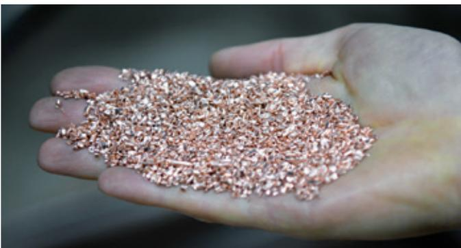
**Vom Altkabel zum wertvollen Rohstoff Kupfer: Moderne Anlagentechnik, die sich sehen lassen kann – das Ergebnis: 40–45 Tonnen Kupfer täglich in nahezu 100-%iger Reinheit. Das gewonnene PVC wird zur Produktion von Absperrtechnik verwendet. Der kunststoffverarbeitende Produktionsbetrieb befindet sich ganz im Zeichen einer funktionierenden Kreislaufwirtschaft am selben Standort.**
