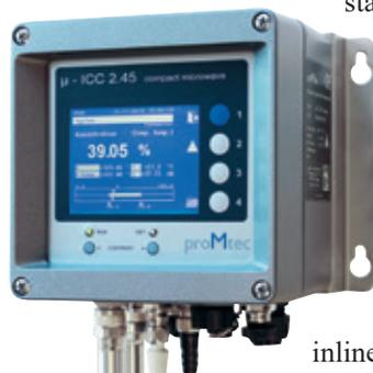
Genau hier setzt die Idee der inline-TS-Bestimmung direkt in der Prozessrohrleitung ein: Mikrowellen werden sehr stark durch Wasser absorbiert. Durch die Messung dieser Absorption kennt man den Wassergehalt und damit direkt den TS-Gehalt. Zur Gewinnung des
